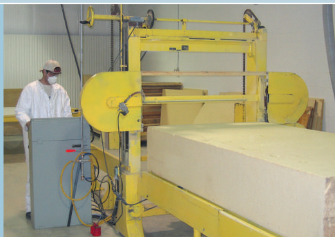
Coupe de feuilles d'Elfoam® sur une scie à trancher de Polybrand
