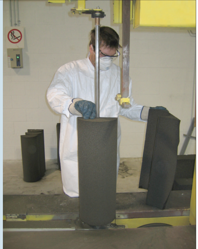
Coupe de l'isolant Foamglas® en demi-coquille.
